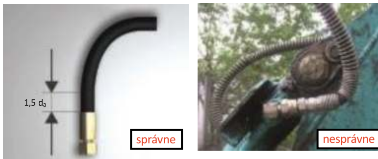
Obrázok 8: správne – rovinný úsek s 1,5 d_a pred ohybom nesprávne – ochranná špirála proti odieraniu hadice nepredstavuje ochrannú koncovku proti zalomeniu
