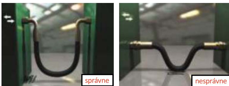
Obrázok 9: Zabránenie opotrebovaniu dostatočným priestorom pre pohyby
